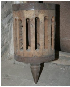
تصویر ۱۲. تصویری از یک توربین قبل از قرار گرفتن پره‌ها داخل چاک‌های آن (مأخذ: نگارندگان).
